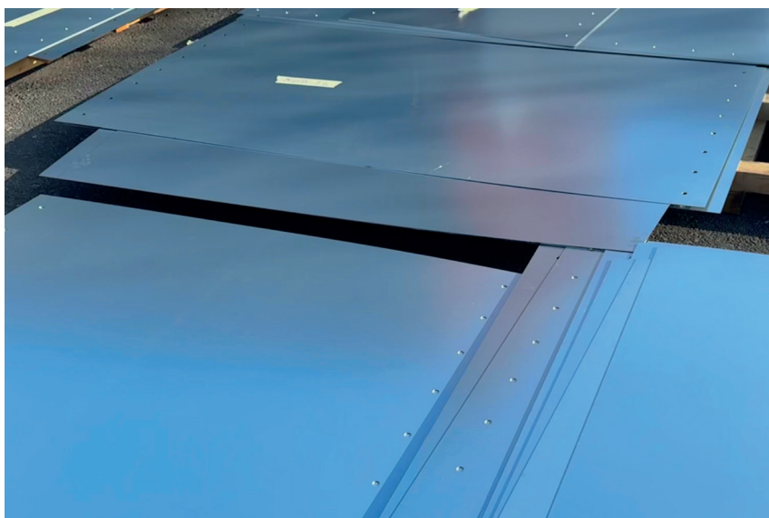
Primjer materijala: pocinčani čelik DX51D+ZM120
